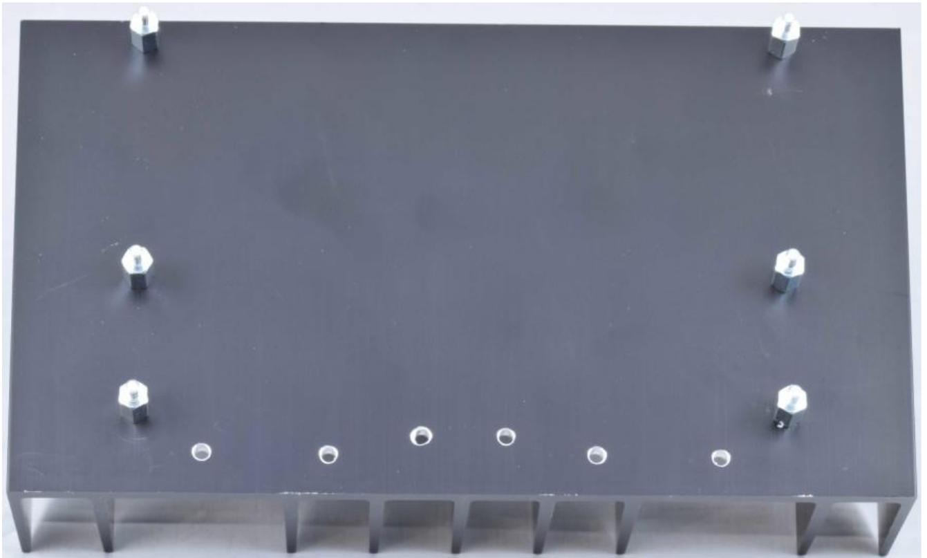
Foto 7 zeigt die Löcher für die 6 Transistoren in der Ausgangsstufe. Platzieren Sie die Transistoren mit Schrauben, müssen Sie sie nicht mit Muttern befestigen, und prüfen Sie, ob die Platine perfekt über alle Stifte und die sechs Abstandshalter gleitet.
