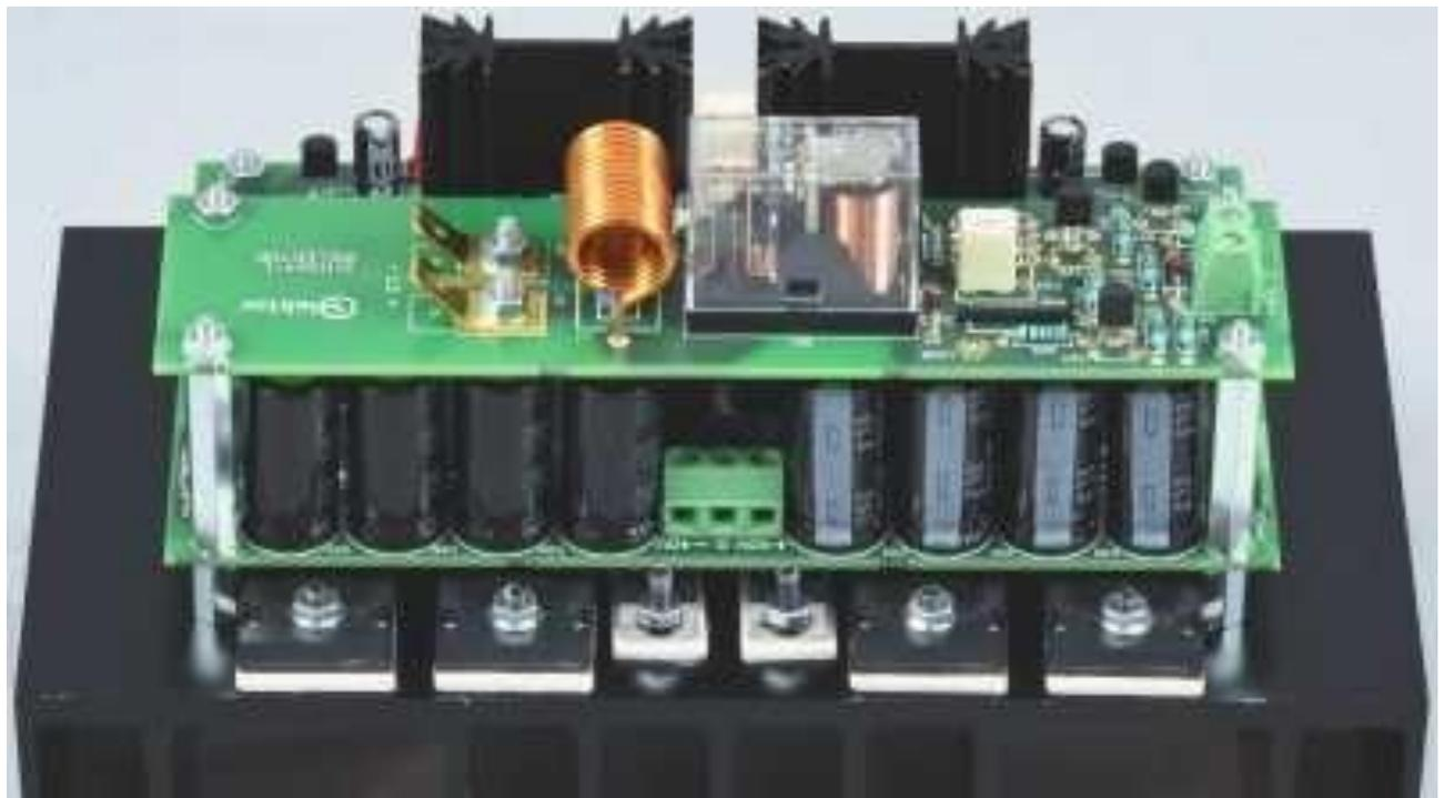
**High-End, THD+N 0,0008 % bei 50 W/8 $\Omega$ , Max. Leistung (THD 1%) 98W/8 $\Omega$  188W/4 $\Omega$ , Massives Modul, alle THT-Komponenten, ThermalTrak-Leistungstransistoren, vollsymmetrischer Aufbau**
