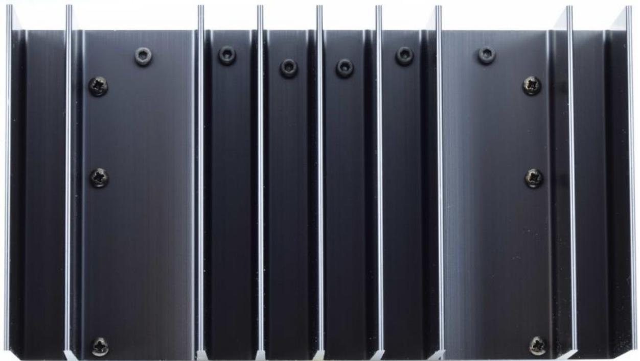
So sieht dann die Rückseite des Kühlkörpers aus. Ich habe die längeren 16-mm-Schrauben für T17/T18 verwendet, aber einfacher ist es, kürzere 12-mm-Schrauben zu verwenden.
