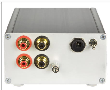
Bild 8. Das Foto zeigt die Anschlussbuchsen und den Schalter auf der Gehäuserückseite.
